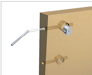
Подготовка деталей для крепежа делается по присадочному чертежу.
