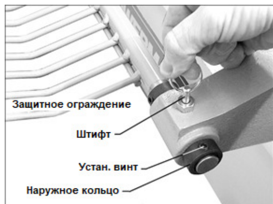
Рис. 6-4: установка защитного ограждения
