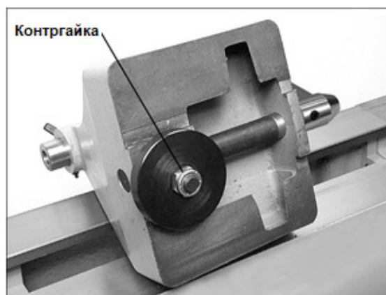
Рис. 8-2: регулировка зажимного эксцентрика
