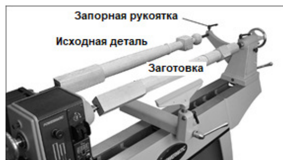
Рис. 8-7: копир (показан с дополнительным удлинением станины на 508 мм)
